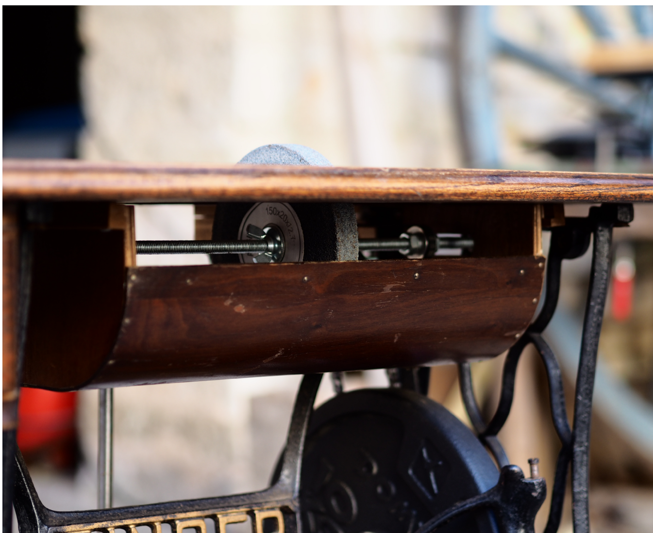
Carter de protection mis en place
