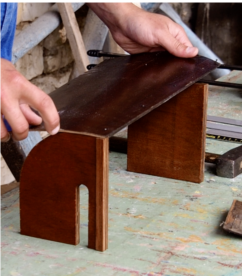
Fabrication du carter de protection
