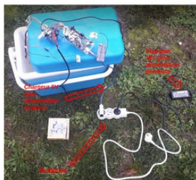
Installation de l'électronique. Détail du système d'alimentation.
