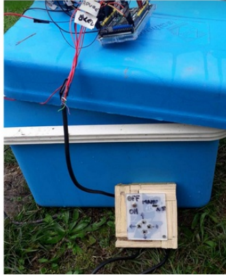
Télécommande avec cadre en bois et surface bouton en plastique. Les boutons dépassent à travers le plastique pour qu'on puisse appuyer dessus. Le bouton ON/OFF et les boutons haut bas ne sont pas opérationnels dans notre développement.
