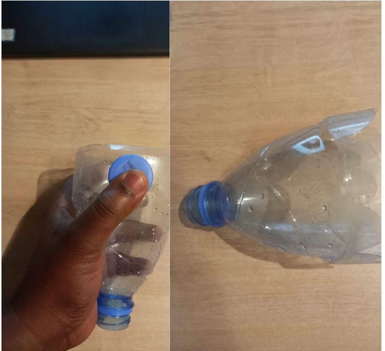
Étape 4 - Perçage du bouchon
